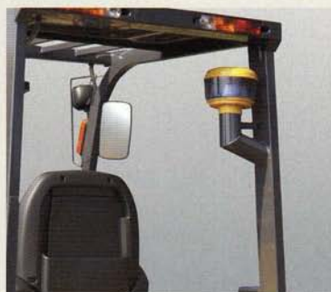
Entrada de aire del motor antes del limpiador
