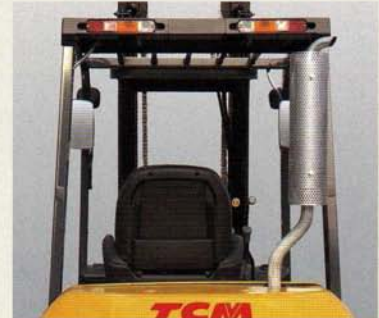
Sistema de escape elevado
